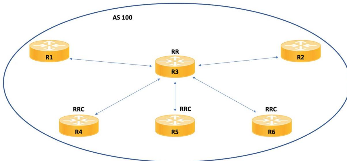
Конфигурация router reflector удивительно проста, поскольку все это обрабатывается на самом router reflector (R3). Клиенты route reflector – это R4, R5 и R6. Они совершенно не знают о конфигурации и настроены для пиринга IBGP с R3 как обычно. Пример 5 показывает пример конфигурации router reflector. Обратите внимание, что это происходит через простую спецификацию клиента router reflector.
