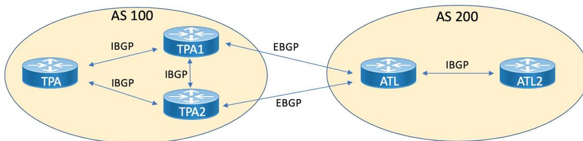
Именно поэтому протокол BGP является протоколом, который обеспечивает функционирование сети. Интернет-провайдеры (ISP) могут использовать BGP для перемещения префиксной информации между другими Интернет-провайдерами. Однако уникальные характеристики BGP на этом не
