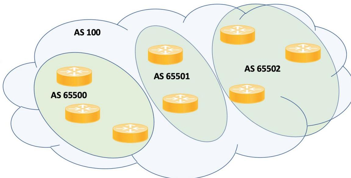
Мы имеем наш AS 100. Для создания конфедерации необходимо создать небольшие субавтономные системы внутри нашей основной автономной системы. Мы их пронумеруем с помощью, номеров автономных систем только для частного использования.
